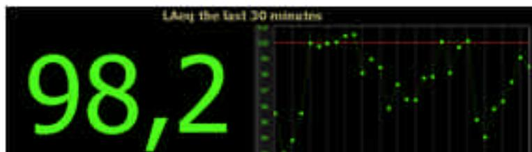
vertegenwoordigt de gemiddelde waarde van 1 minuut. De grafiek is erg nuttig omdat de persoon die het geluidsniveau controleert zo op een eenvoudige manier weet of er nog “geld op de rekening staat” om het gemiddelde niveau op te trekken. De grafiek zal minimaal 15 minuten geschiedenis tonen, d.w.z. dat indien de Leq-periode op 3 minuten is ingesteld, er nog steeds 15 punten op de grafiek zullen staan.
