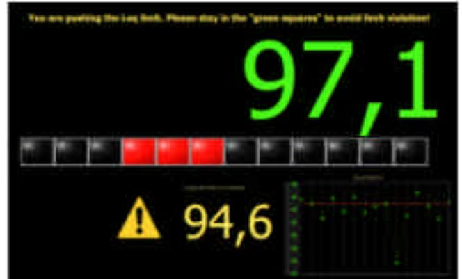
Een knipperende waarschuwing wordt getoond – risico van limietoverschrijding indien het volume niet verlaagd wordt totdat enkel nog groene vakjes zichtbaar zijn.
