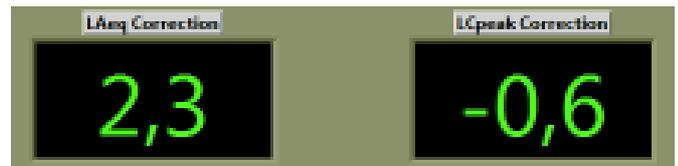
Dit geeft het niveauverschil weer tussen wat er effectief wordt gemeten door 10EaZy en wat 10EaZy zou meten indien het systeem op het referentiemeetpunt zou staan. Op dezelfde manier wordt van de C-gewogen waarde 0,6dB afgetrokken. Doordat de sub onder het balkon opbouwt, zal de C-gewogen waarde hoger zijn dan er effectief op het referentiemeetpunt in het publiek gemeten zou worden.
