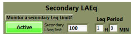
Indien u een systeem heeft aangekocht met de optionele DIN I 5905-5 -functie (enkel van toepassing in Duitsland), zal de Leq-limiet set-up vaststaan op het 30 minuten/99 dBA-gemiddelde maw de DIN I 5905-5-standaard.
